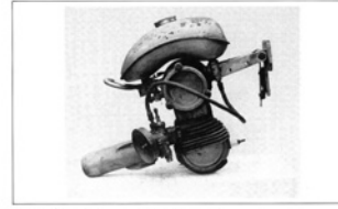
Merk : POWERPAK Bouwjahr : 1962 Made in : Engeland Cil. Inhoud : 48cc Aandrijving : Rof Bijzonderheden : De roosaandrijving drijft het achterwiel aan.
