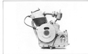
Merk : DUCATI CUCCILO Bouwjahr : 1946 Made in : Italië Cil. Inhoud : 48cc Aandrijving : Met ketting Bijzonderheden : Dit motorje is een kopklepper
