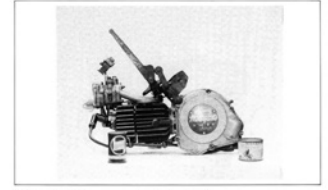
Merk : MOSQUITO Bouwjahr : 1963 Made in : Italië Cil. Inhoud : 48cc Aandrijving : Rof Bijzonderheden : Het is een type 38-B
